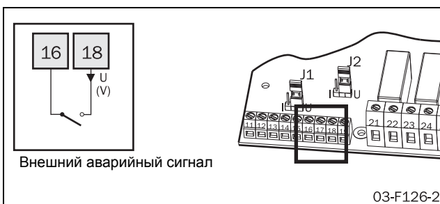
Рис. 68 Соединение клемм для внешнего аварийного сигнала
