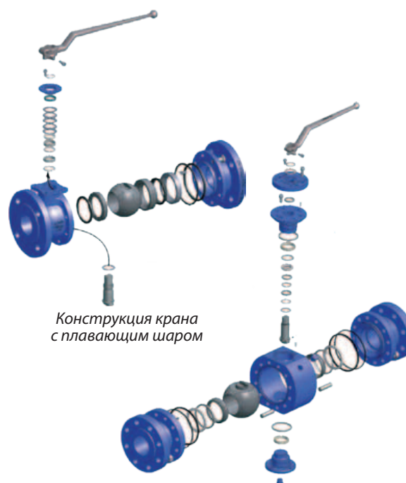
Конструкция крана с двумя опорами шара
