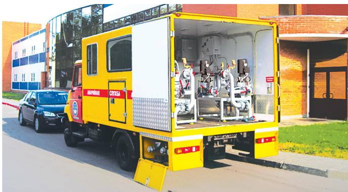
Станция аварийного водоснабжения на базе автомобиля
