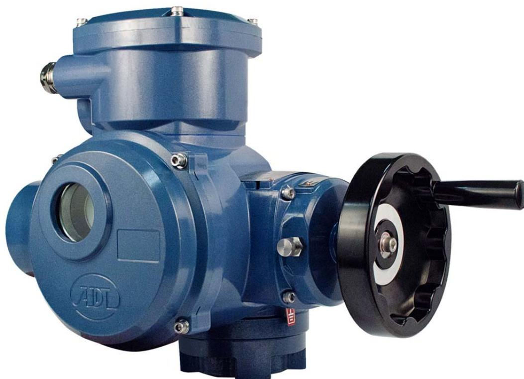
**Электропривод СМАРТГИР® серии AZ** – это многооборотный электропривод с крутящим моментом от 100 до 3500 Нм, который также может оснащаться четвертьоборотным редуктором. Привод в механической части состоит из червячного редуктора и представляет собой крестообразную конфигурацию с отсеками под электродвигатель, блок управления и модуль ручного дублера.
