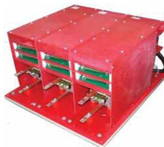
Рис.2. Силовая часть (тиристорный модуль)
