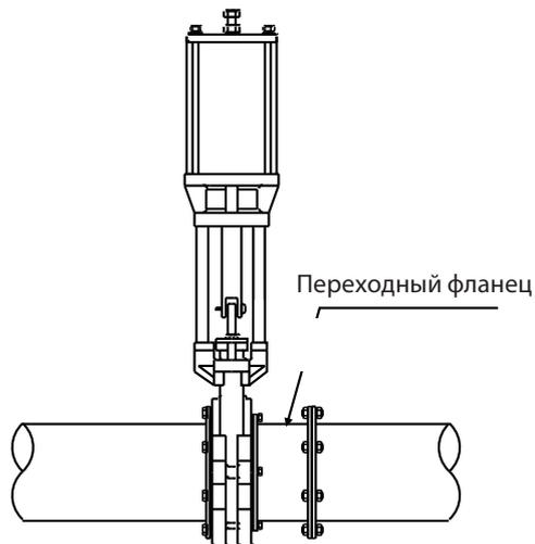
При установке квадратного ножевого затвора в трубопроводе необходимо предусмотреть специальный переходный фланец для квадратной стороны клапана.
