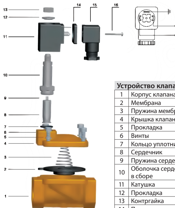
Устройство клапана KSP
