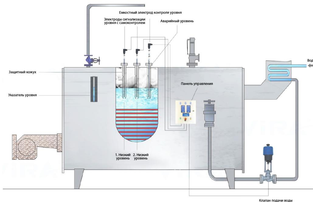
Высокая надежность, пропорциональная система контроля уровня с функцией самоконтроля
