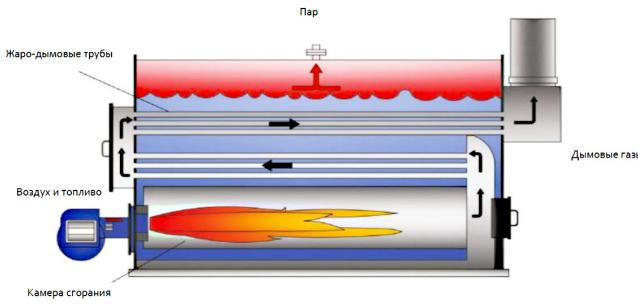
Жаро-дымотрубные котлы, как правило, характеризуются количеством проходов. Учитывается количество проходов, при этом дымовые газы обеспечивают передачу тепла воде через котел. Он предназначен для передачи максимальной энергии дымовых газов воде до момента ее выхода из котла путем направления дымовых газов в противоположных направлениях в каждом проходе.
