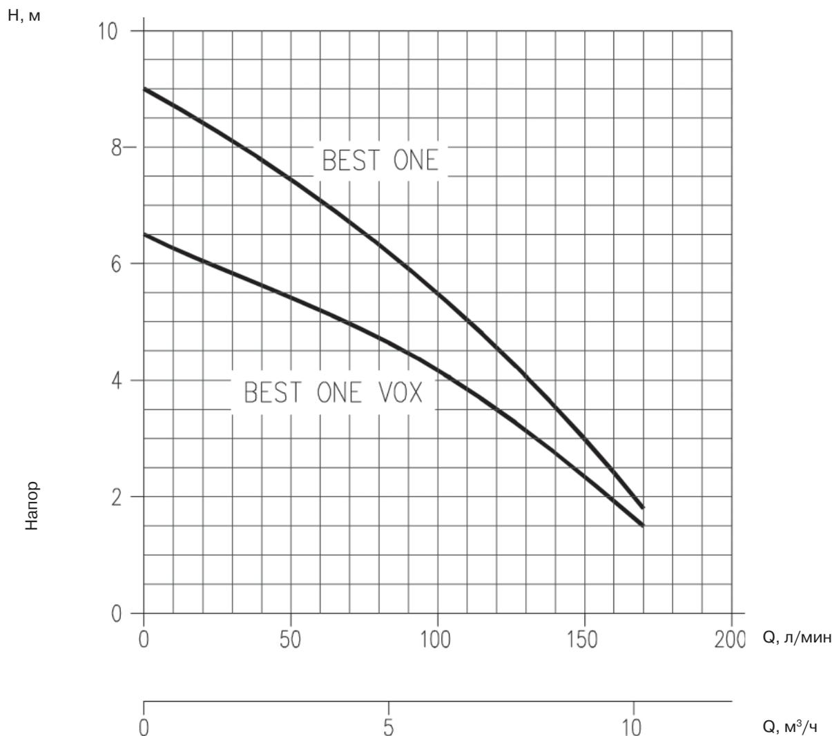
BestOne — насосы с одноканальным рабочим колесом
