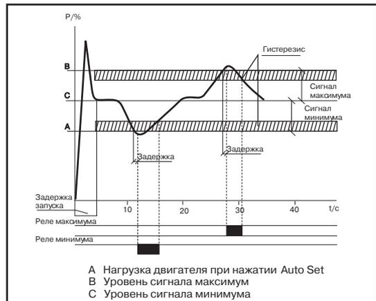
Монитор EL-FI® M20 запрограммирован как монитор перегрузки и недогрузки. Уровни срабатывания запрограммированы с помощью кнопки «Auto Set», задержка срабатывания 0,5 с, основной сигнал без блокировки.
