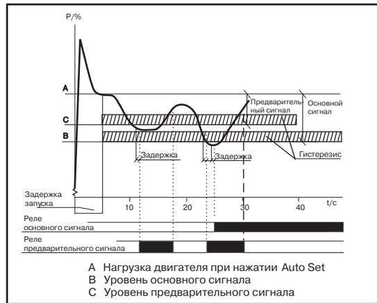
Монитор EL-FI® M20 запрограммирован как монитор недогрузки с предварительным сигналом. Уровни срабатывания запрограммированы с помощью кнопки «Auto Set», задержка срабатывания 0,5 с, основной сигнал с блокировкой.
