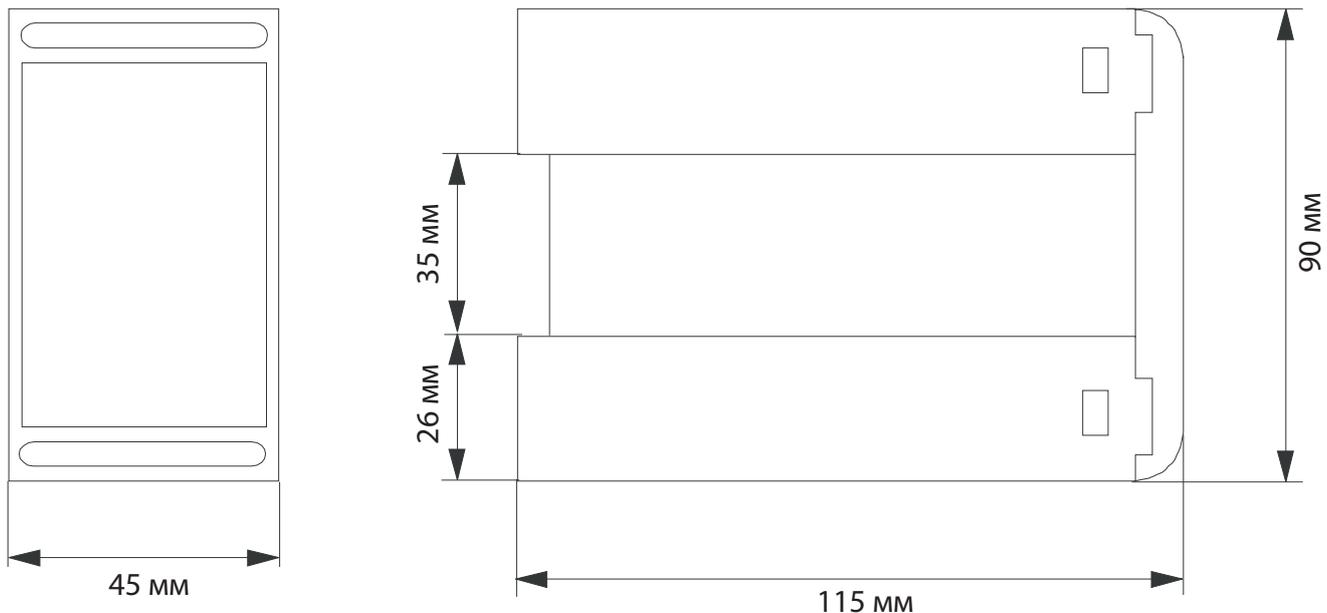
**МОНИТОР НАГРУЗКИ ДВИГАТЕЛЯ EL-FI M20**
