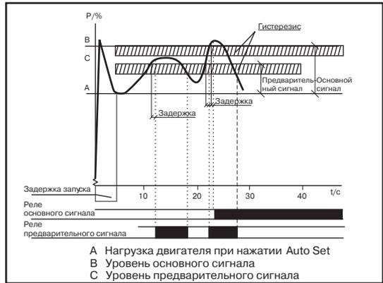
Монитор EL-FI® M20 запрограммирован как монитор перегрузки с предварительным сигналом. Уровни срабатывания запрограммированы с помощью кнопки «Auto Set», задержка срабатывания 0,5 с, основной сигнал с блокировкой.
