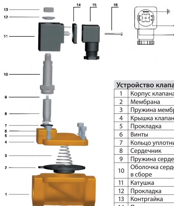
Устройство клапана KSP
