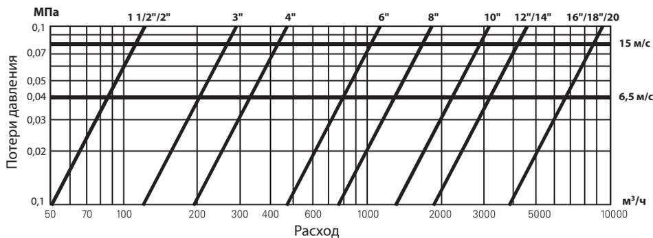
Для предохранительных клапанов, клапанов защиты от гидроудара.
