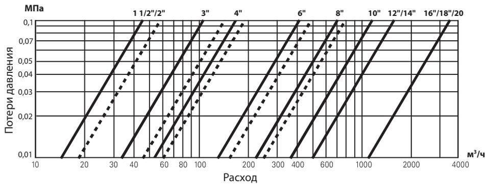
Для клапанов, управляемых соленоидами, редукционных клапанов с трехходовым пилотом, клапанов для управления расходом, клапанов для управления насосами.
