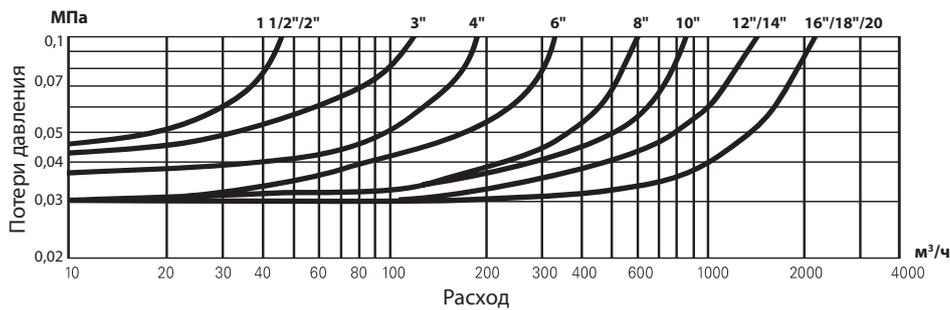
Для перепускных клапанов, пропорционального снижения давления, клапанов с электронным управлением, клапанов, поддерживающих разность давления, для поплавковых клапанов.
