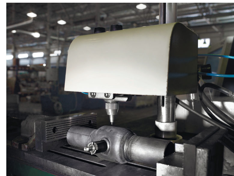
▲ Рис. 2. Все краны имеют индивидуальный серийный номер и маркировку, нанесенную механическим методом на корпус
