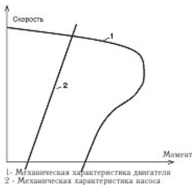
Рис. 1. Механическая характеристика двигателя и нагрузочная диаграмма насоса
