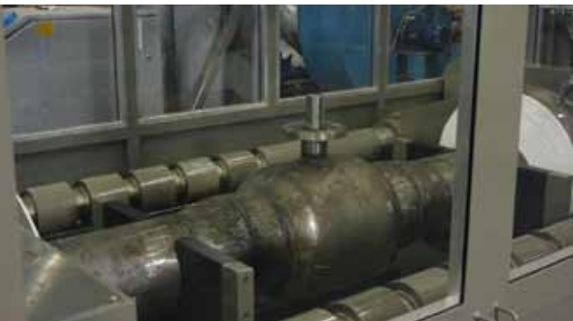
Автоматизированный тестировочный стенд для шаровых кранов с удлиненными патрубками
